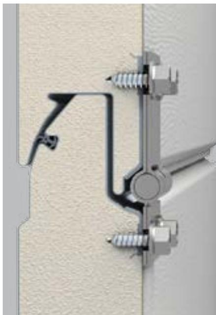
Les vis auto-perceuses sont placées à la jonction des tôles en acier tout en traversant **4 couches de métal** pour une résistance accrue. Un scellement robuste exclut tout cintrage d'un panneau suite à la chute inopiné du panneau.
