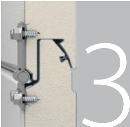
Nos panneaux sandwichs sont constitués de tôles d'acier serties. Cette configuration protège les panneaux contre le cintrage par exposition au soleil, ainsi que des chocs en cas de chute des portes intempestive. La durée de vie des portes s'en trouve ainsi prolongée.
