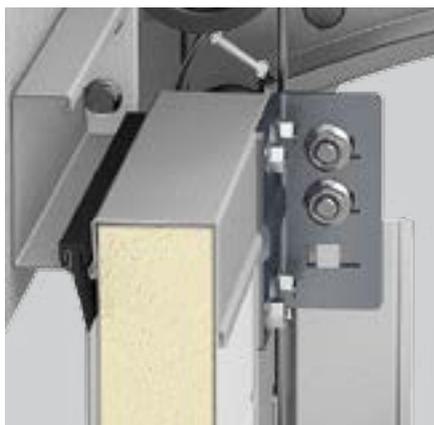
**Les supports de galet réglables** permettent une étanchéité parfaite entre le tablier et les joints. Ainsi le garage est protégé des courants d'air et conserve la chaleur.
