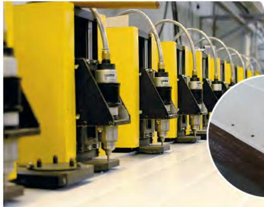
Vorgefertigte Bohrungen auf dem Werk
