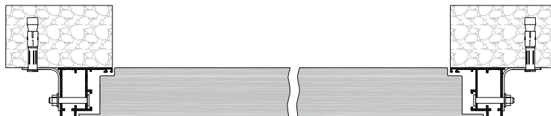
Installation in the opening type 2/In die Öffnung integrierte Montage Typ 2/Montage dans la baie type 2
