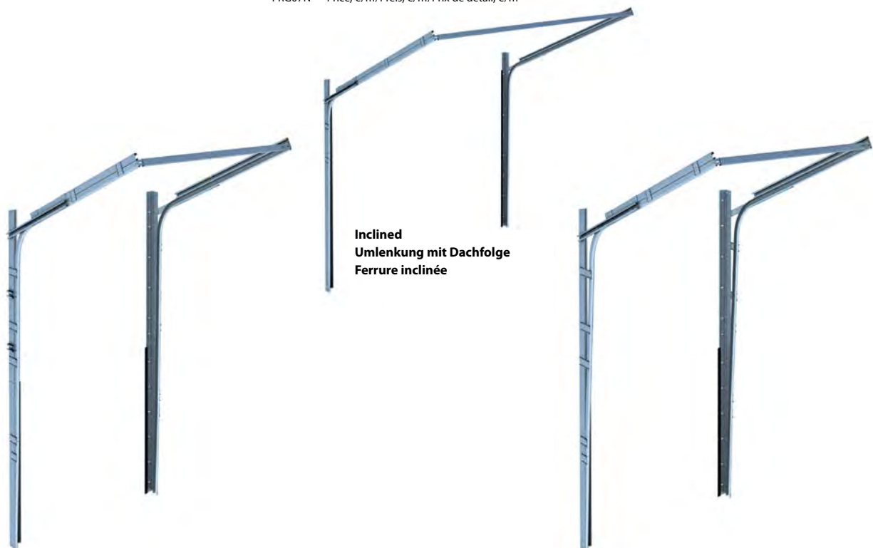
Inclined high mounting with bottom spring positioning Hochgezogene Umlenkung mit Dachfolge und unten liegender Welle Ferrure haute inclinée avec arbre en position basse
