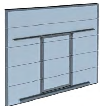
Wicket with standard threshold Schlupftür mit Standard-Schwelle Portillon à seuil standard
