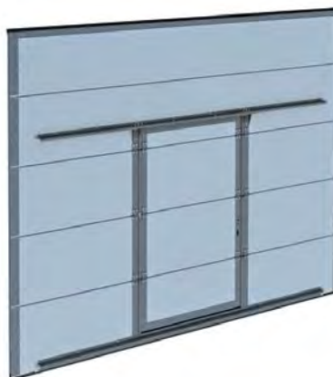
Wicket with low threshold Schlupftür mit niedriger Schwelle Portillon à seuil bas
