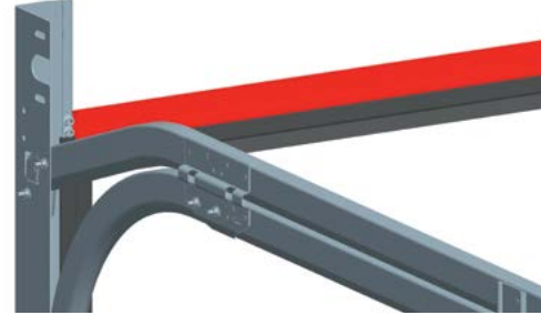
Angle profile (PRG055) Blendenschiene (PRG055) Profilé de façade (PRG055)
