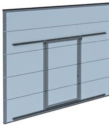
Wicket with low threshold Schlupftür mit Niedrigschwelle Portillon à seuil bas
