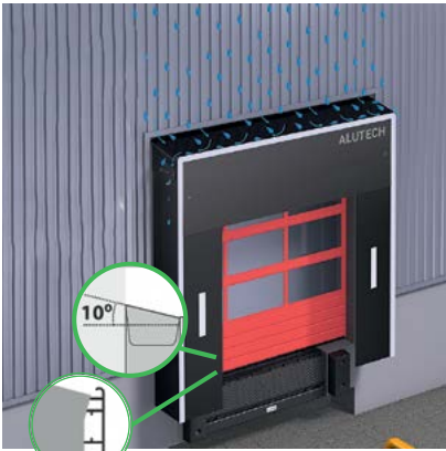
Уклон верхнего перекрытия под углом 10° вперед и передние профили с желобами обеспечивают отвод воды.
