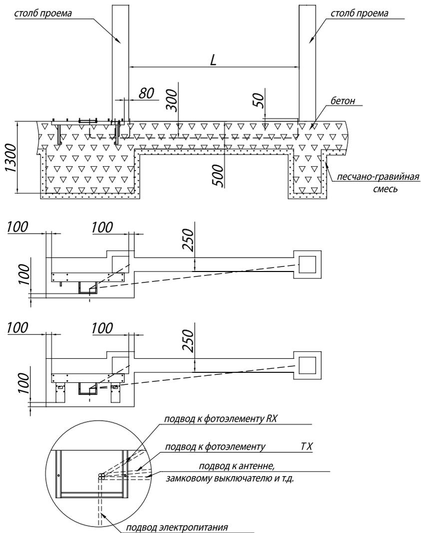
Рис. 76. Размеры фундамента и расположения опорной площадки под откатные самонесущие ворота, изготовленные на профиле 68 мм
