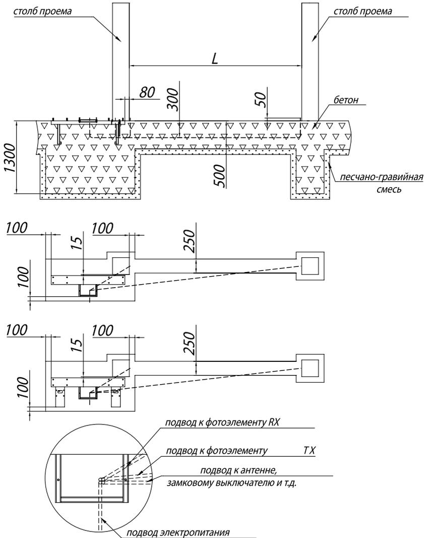
Рис. 7а. Размеры фундамента и расположения опорной площадки под откатные самонесущие ворота, изготовленные на профиле 96 мм
