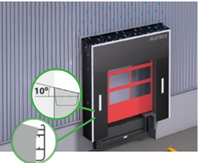
Уклон верхнего перекрытия под углом 10° вперед и передние профили с желобами обеспечивают отвод воды.
