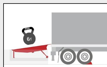
4. Не заезжайте на платформу, если вес груза с погрузчиком превышает допустимый вес **max 6 тонн** (с учетом погрузчика)
