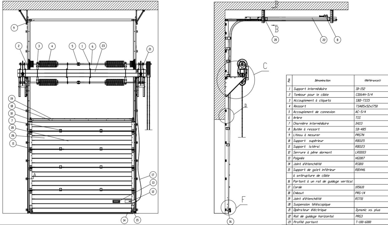
Schéma de montage des portes
