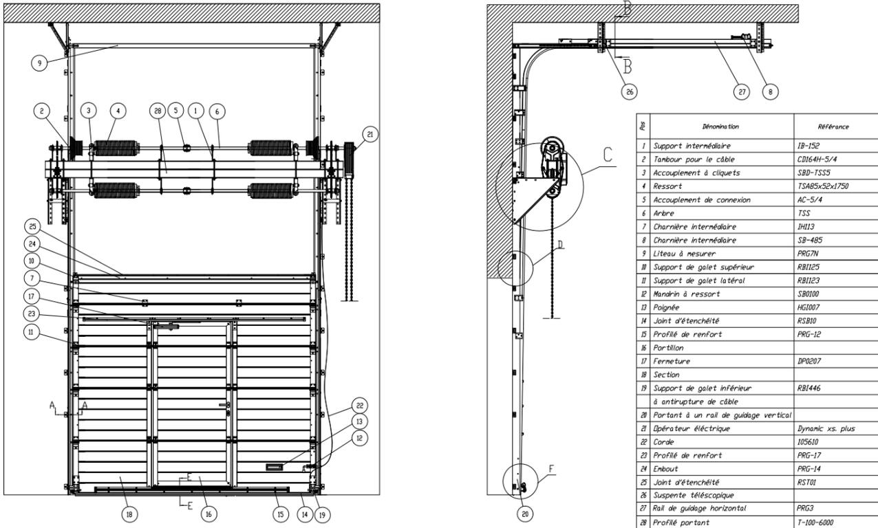
Schéma de montage des portes
